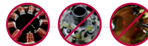
Stopienie się izolacji wewnętrznej Zapłon oleju Spalenie wirnika
