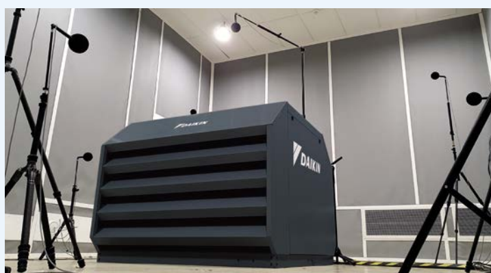
Pomiar poziomu mocy akustycznej w komorze akustycznej
