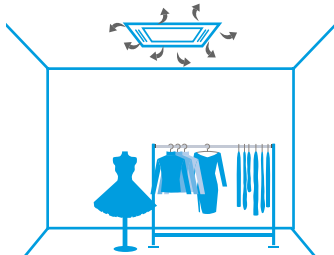
Rozkład powietrza z zabrudzonym filtrem
