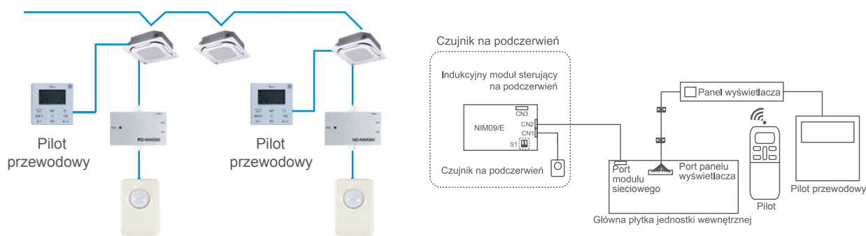
NIM09 współpracuje z pilotem przewodowym
